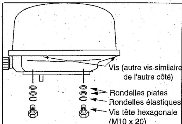
Antenne, emplacement des accessoires de fixation.
