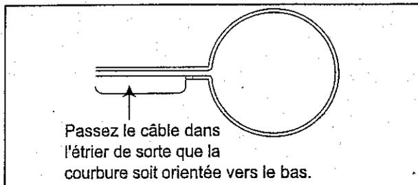
*Platine de fixation de la ferrite*
